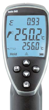
Náhled displeje přístroje při připojení dotykové teplotní sondě: emisivita a aktuální teplota měření infračerveným paprskem a dotykovou sondou.
