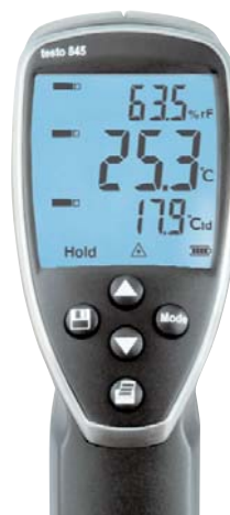
Náhled displeje přístroje s integrovaným vlhkostním modulem: aktuální hodnota relativní vlhkosti, teploty a teploty rosného bodu.
