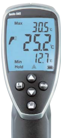
Náhled displeje přístroje při měření infračerveným paprskem: aktuální teplota, hodnota min./max.
