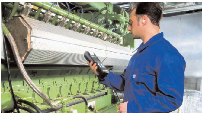
testo 350-XL: mobilní měření motorů (O 2 , CO, NO, NO 2 )
