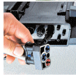
Robustní kombinovaný konektor pro připojení spalin a diferenčního tlaku
