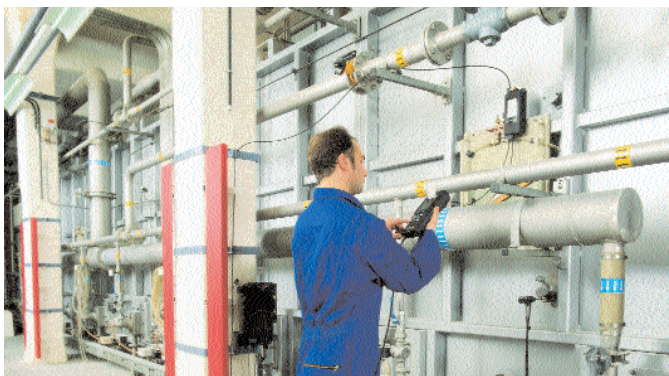
testo 350-S: sestava pro rychlou kontrolu emisí u průmyslových tepelných zařízení (O 2 , CO, NO)
