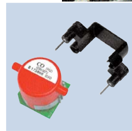
Vyhřívání senzorů – chrání senzory před poškozením případnou tvorbou kondenzátu a zvyšuje rychlost odezvy u senzorů při nízkých teplotách okolí
