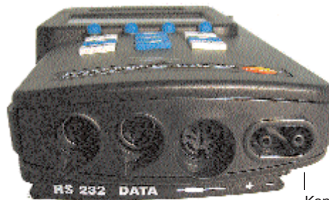
Konektor RS232 Konektor pro databus Testo Konektor pro další sondu Konektor pro měření diferenčního tlaku/proudění
