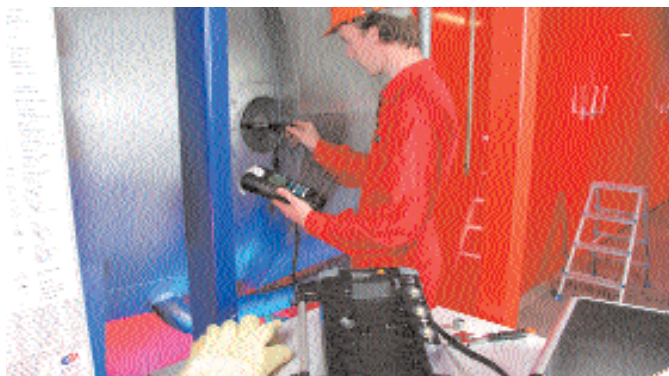
testo 350-XL: mobilní měření na turbínách (O 2 , CO low , NO low , NO 2 )
