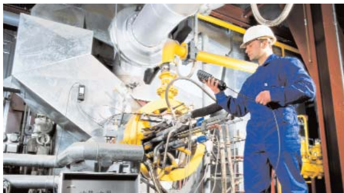
testo 350-XL: standardní sestava pro měření spalovacích zařízení (O 2 , CO, NO, NO 2 )
