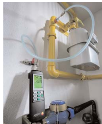
NOVINKA: kontrola regulátoru tlaku plynu (Záznam naměřených hodnot za časový úsek, např. 24 hod.)
